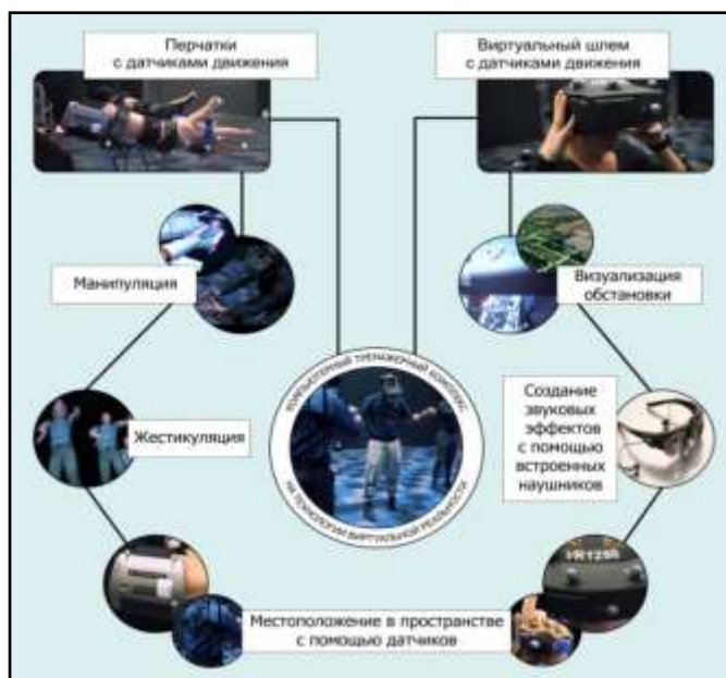
Рисунок 65 – Схема реализации технологии виртуальной реальности в компьютерных тренажерных комплексах
